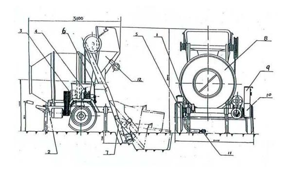
Fig. 1. VIEW OF REVERSE CONCRETE MIXER
